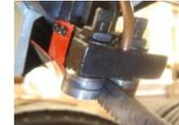
Roulements de guidage de la lame
